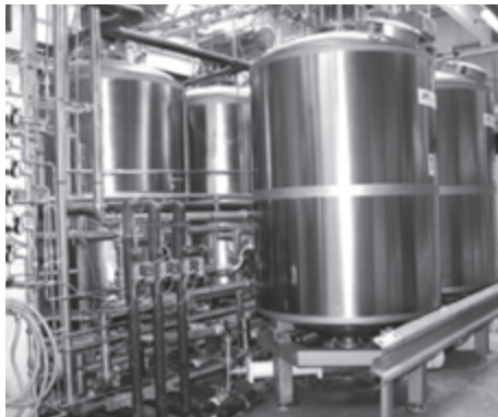
図6 小麦粉サワー種とフォアタイクの発酵／貯蔵タンク
