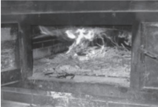
(A)に示しました。詳しい構造は教えてもらえませんが、この窯の燃料には(B)に示した薪をパレット状に加工したものが使用されます。この加工もベーカリーが独自に考案したようで、燃焼による煙が少ない特徴があり、通常の薪窯以上に排煙が少なく、環境への配慮がなされています。この薪パレットを(C)に示した窯の背面にある複雑な構造の自動燃焼システム
